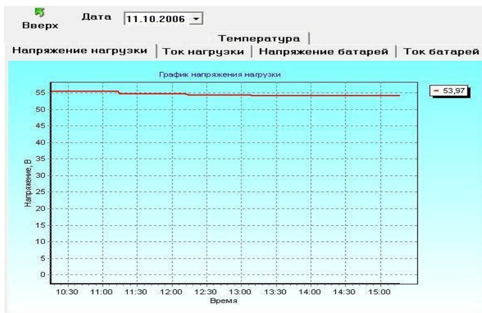
Рис. 117. Графики основных параметров устройства «Контроллер микропроцессорный»
